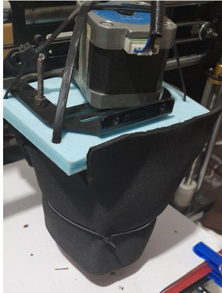
Figura 3.9. Solución a pérdidas de calor exteriores.
