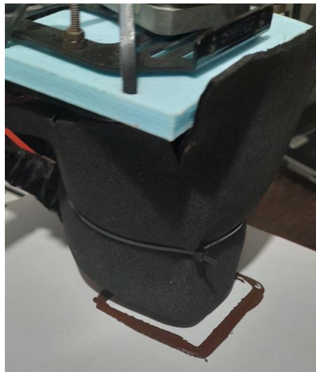
Figura 3.10. Prueba reduciendo pérdidas de calor exteriores.
