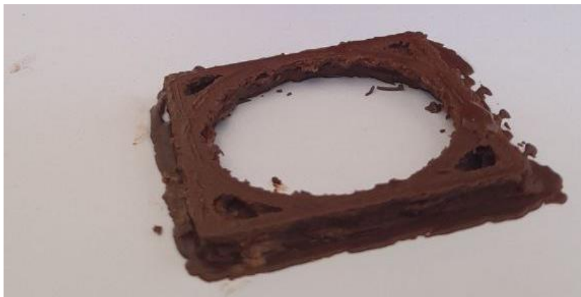
Figura 3.12. Figura impresa mediante la impresora 3D de chocolate.
