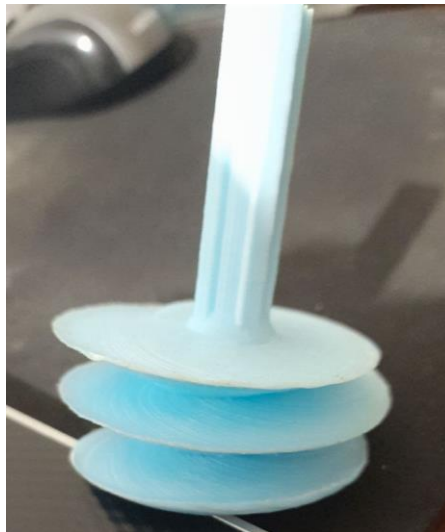
Figura 2.11. Tornillo dispensador impreso.
