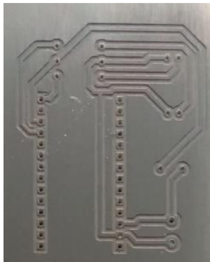
figura 2.13 Lámina de cobre terminada para la PCB del circuito principal.
