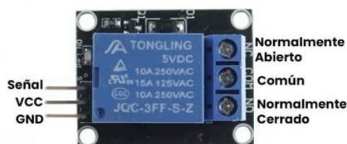
figura 1.17 Salidas y Entradas específicas del módulo Relé y alimentación VCC a 5V
