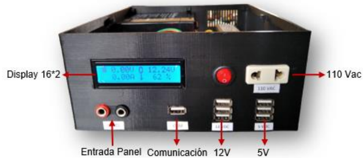
Figura 3.7. Prototipo del sistema fotovoltaico diseñado.
