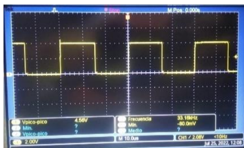
Figura 3.13. Forma de onda de 33KHz disparo MOSFET conversor
