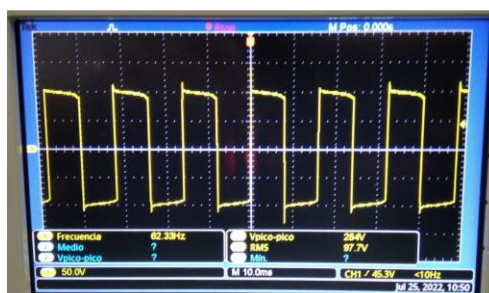
Figura 3.16. Forma de onda de la salida de 110V AC 60Hz.
