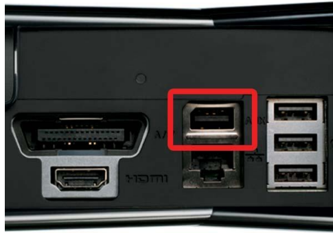
Figura 2.1. Dispositivo Kinect (parte superior) Puerto de conexión al dispositivo Kinect (parte inferior). [20]
