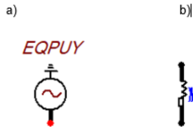
Figura 29. Modelos para representar el equivalente de red. a) Fuente Type 14. b) Symmetric RL coupled line.
