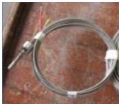
Figura 2.10. Termocuplas para las zonas de calentamiento
