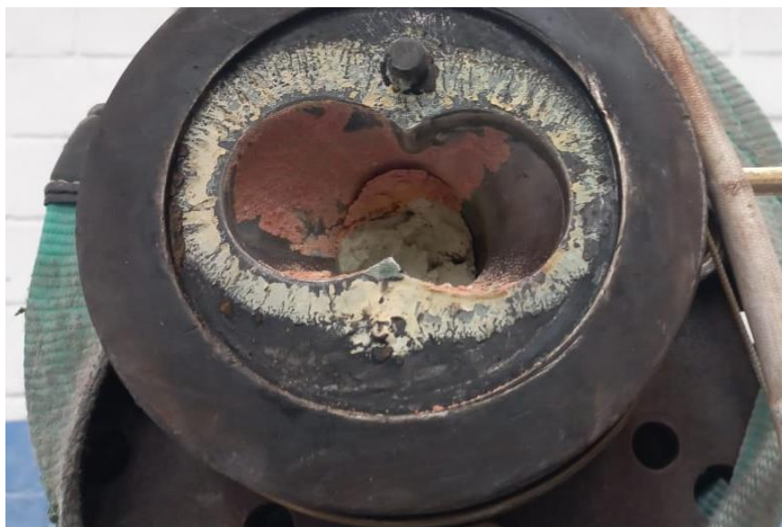
Figura 1.5. Compuesto pegado en el reductor de cabezal de extrusión por desgaste de cromo
