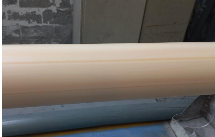
Figura 1.6. Rayas de quemado en tubería de PVC
