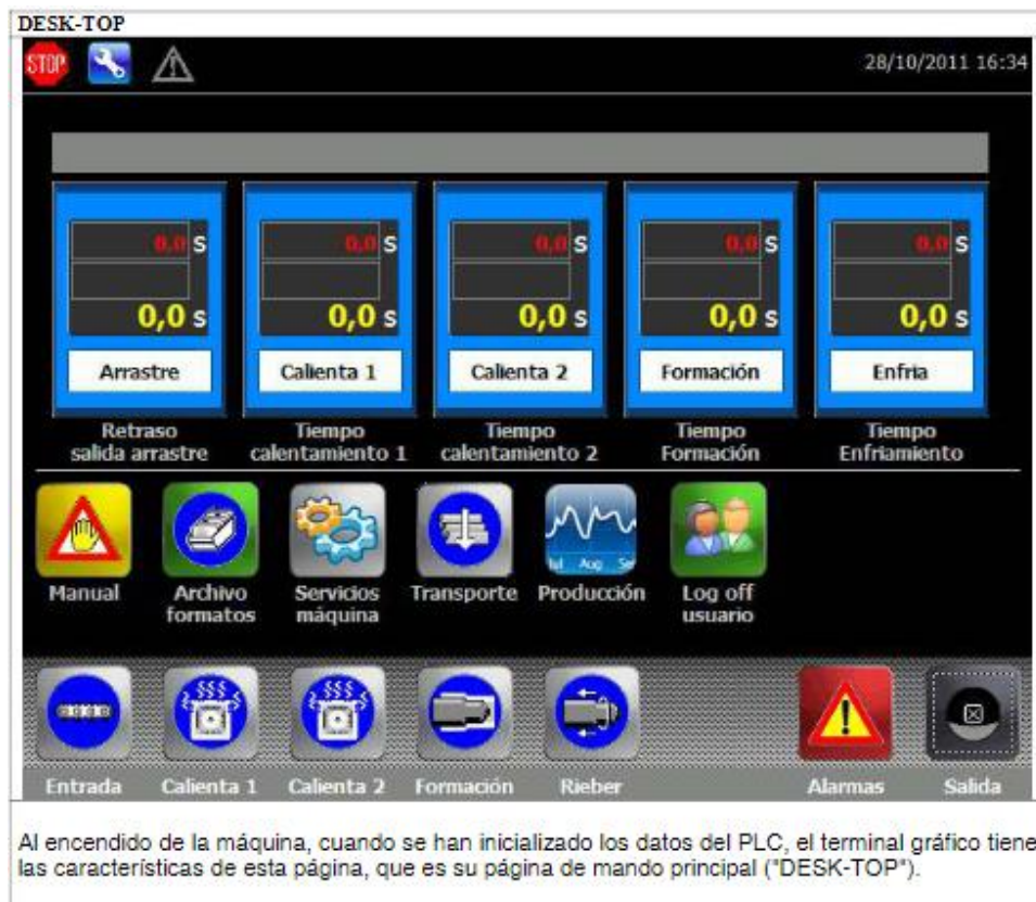
Figura 2.18. Interfaz del panel de control (Fuente: (S.r.l., 2011))
