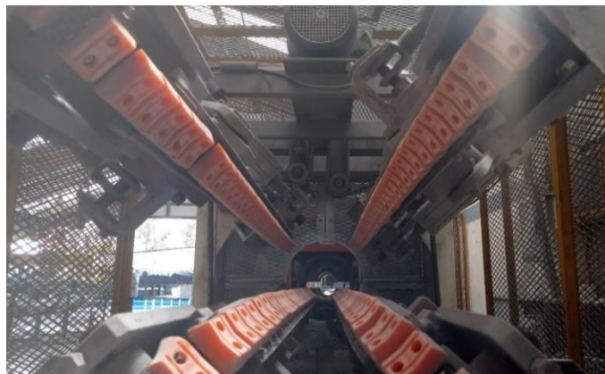
Figura 2.15. Orugas de transporte del jalador
