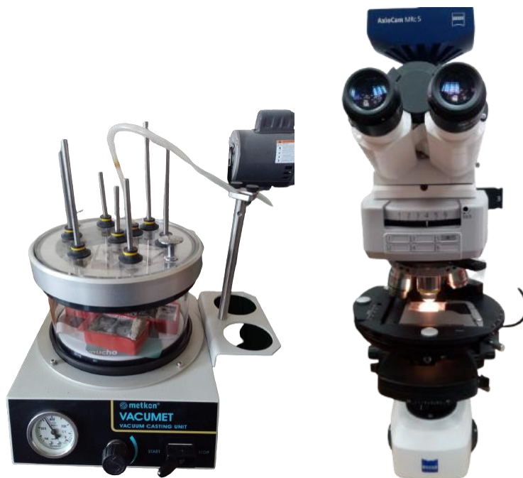
Figura 2.10. Instrumentos utilizados para el análisis petrográfico. Izquierda: Máquina de impregnación. Derecha: Microscopio petrográfico del Laboratorio del Instituto Geofísico EPN.
