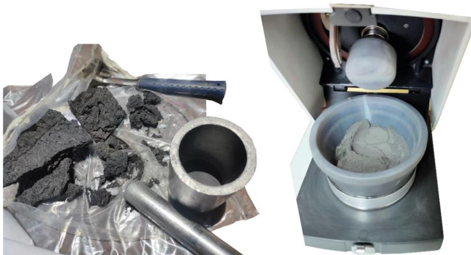
Figura 2.11. Trituración de muestras de roca. Izquierda: mortero de titanio. Derecha: Molino de ágata Retsch RM 200 (Calderón, 2022).
