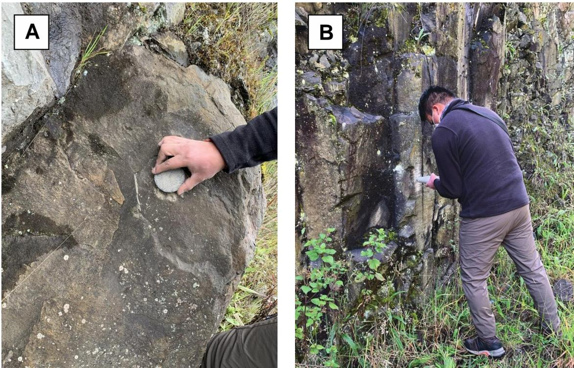
**Figura 3.1** Ensayo de compresión con martillo de Schmidt. A) Alisamiento de superficie. B) Medición de la resistencia.
