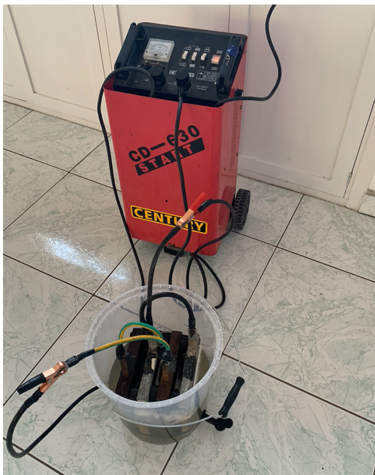
Figura 13. Equipos utilizados en el proceso de electrocoagulación. Fuente: Alex Salazar, 2022
