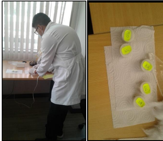
Figura 3.9 Preparación y montaje de muestras en cápsulas para geoquímica con XRF.
