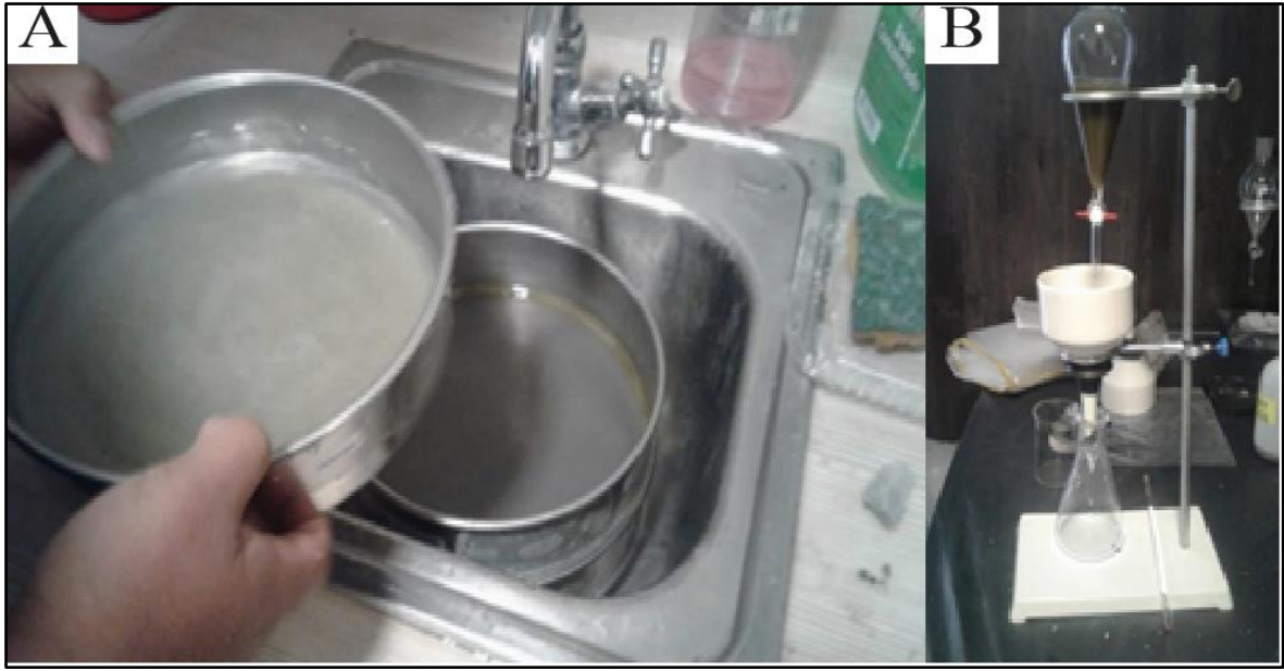
Figura 3.11 A) Tamizaje de la muestra triturada, B) separación con liquido pesado de la muestra fina
