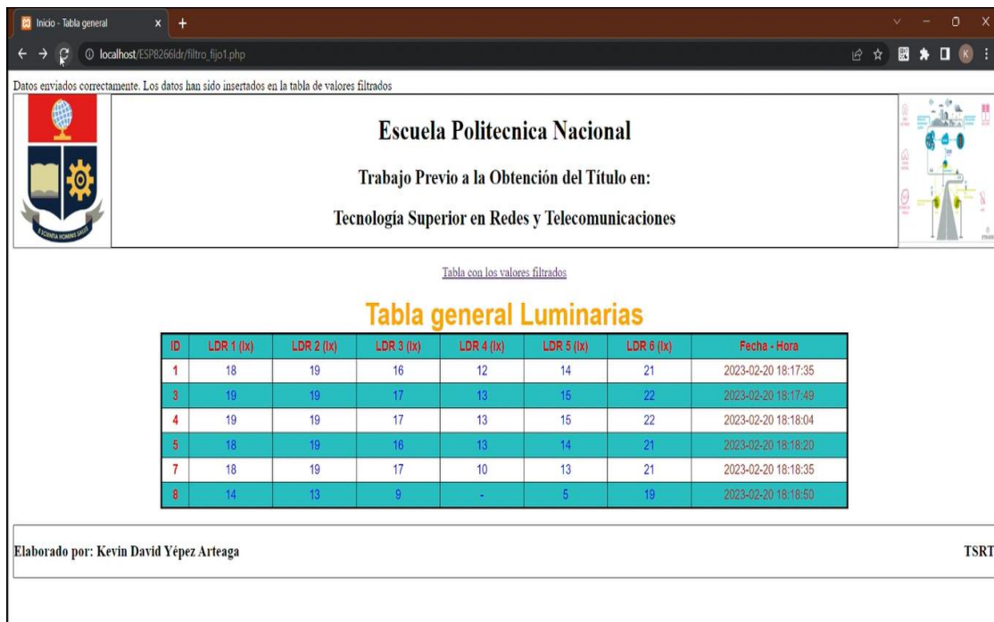
Figura 3.36: Intensidad de luminosidad detectada por los sensores.
