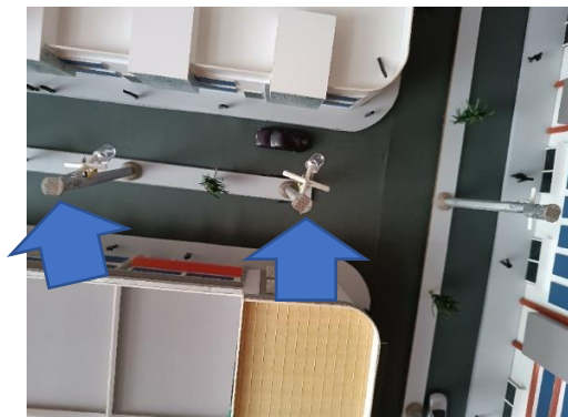
Figura 3.35: Disposición de las LDR en la maqueta.
