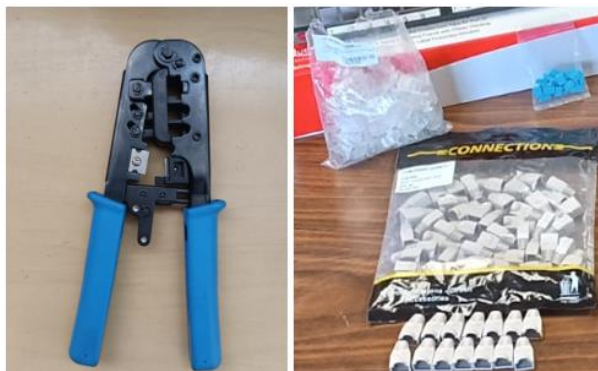
Figura 3.22 Materiales para el ponchado de los patch cords
