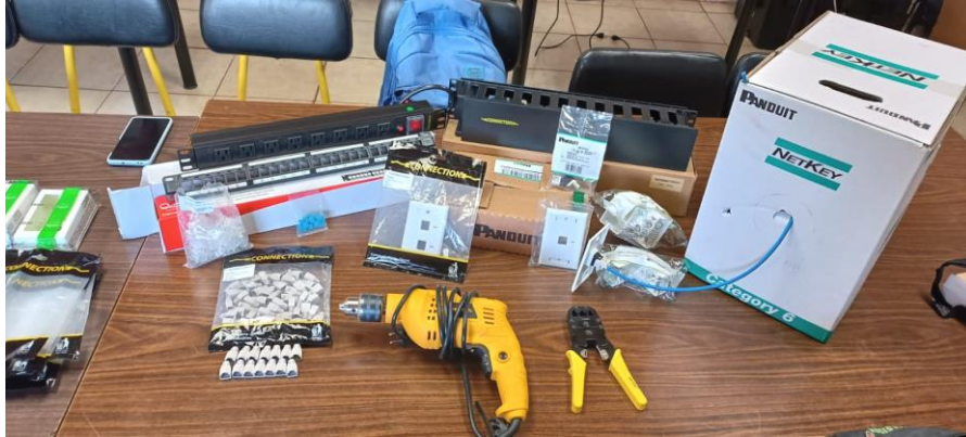
Figura 3.11 Elementos adquiridos para la instalación del SCE
