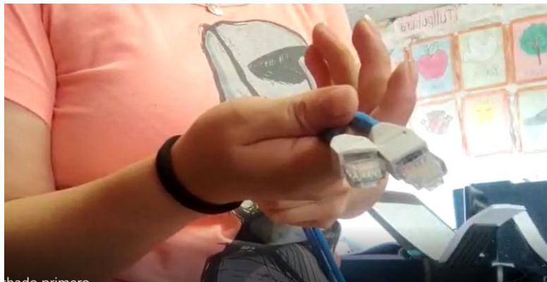
Figura 3.23 Creación de patch cord con protección
