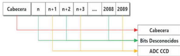
Fig. 16. Estructura de la trama del espectroradiómetro que contiene el dato de valor.
