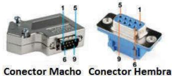
Fig. 2. Conectores DB9 Macho y Hembra.
