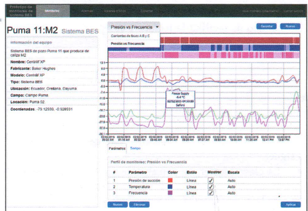
Fig. 8. Vista principal de monitoreo. En la parte izquierda del gráfico y los controles, se puede apreciar la información completa del equipo monitoreado
