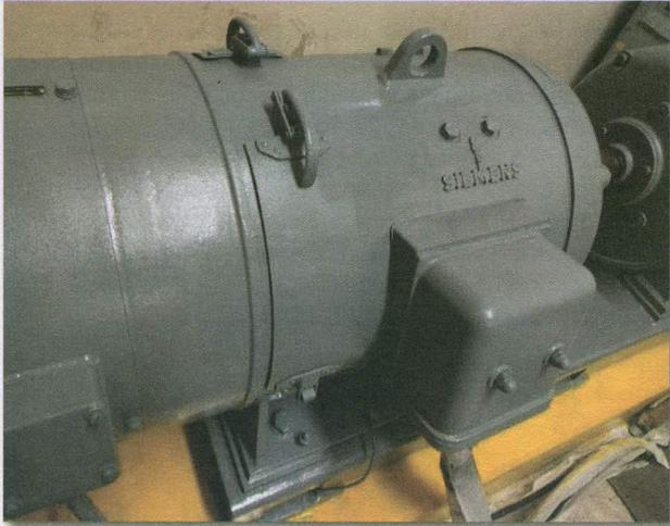
Figura 11. Trabajo de Pintura en Carcazas y Bases de Máquinas
