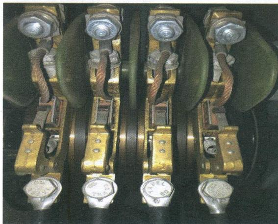
Figura 10. Mantenimiento e Inspección de Escobillas
