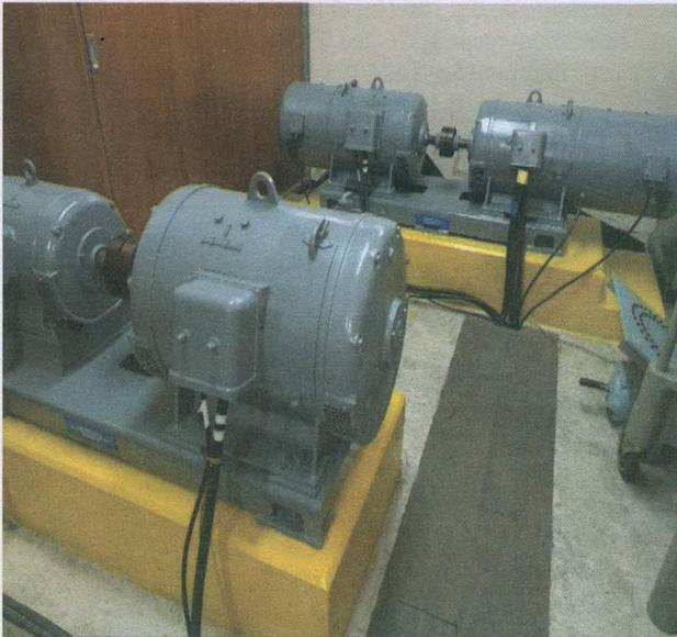
Figura 12. Estado de Entrega del Equipamiento Ward Leonard al Laboratorio de Máquinas Eléctricas
