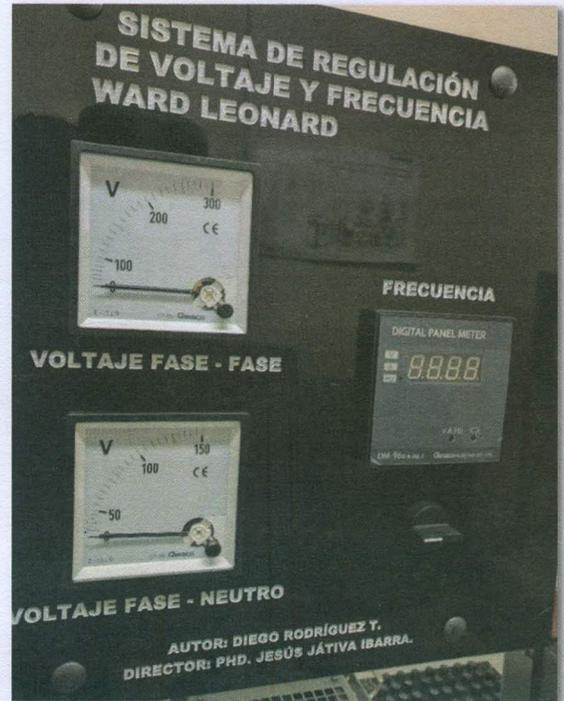
Figura 15. Nuevo Panel de Mediciones que Permite Regulación Manual In Situ
