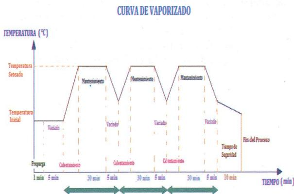
Fig. 8. Curva del proceso de vaporizado
