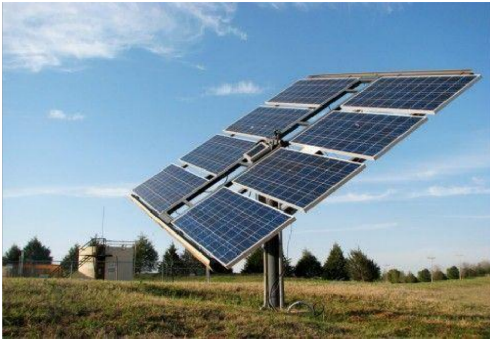
Figura 2.15. Estructura de montaje móvil [37].
