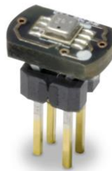
Figura 13. Sensor BME280 de Libelium. [17]
