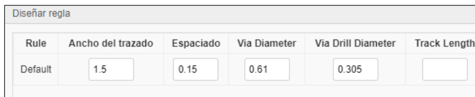
Figura 2.22 Diseño de las reglas de los caminos de la placa PCB en EasyEDA.
