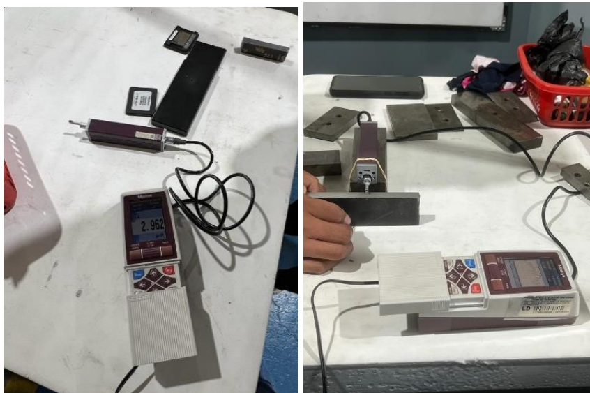
Figura 3.3 Medición de la rugosidad con el Rugosímetro Mitutoyo SJ-210.
