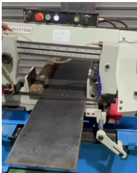
Figura 2.6 Material a cortar plancha de acero A36
