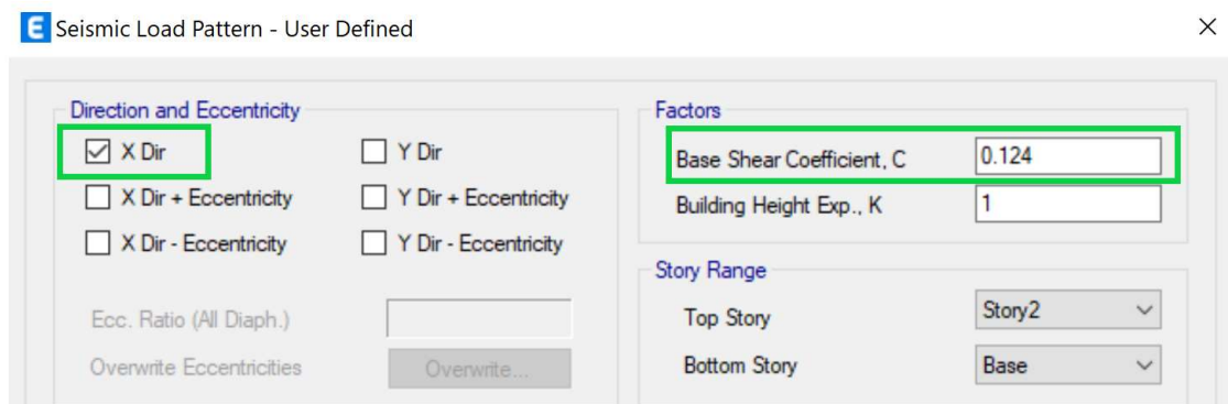
Figura 2.1.2: Definición de Carga Sísmica en X, ETABS
