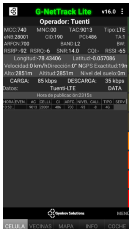
Figura 1.7 Información de la estación base analizada mediante G-NetTrack Lite
