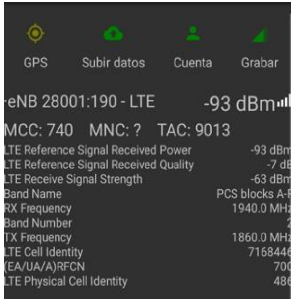
Figura 1.2 Detalles de medición en la ventana de "Celda" en CellMapper
