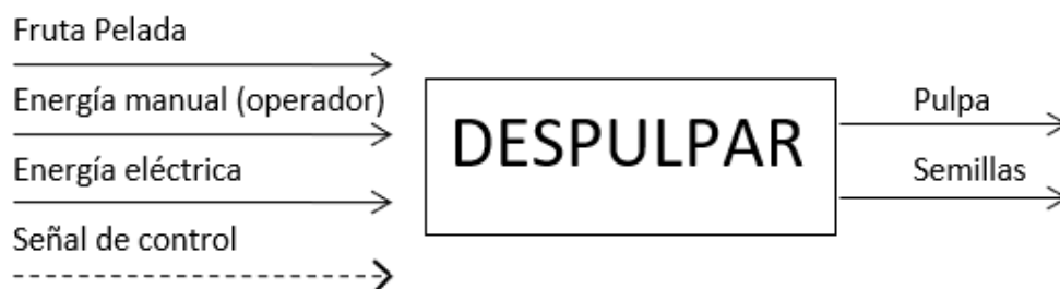
Figura 14. Nivel funcional 0 de la máquina despulpadora de fruta. Fuente: Propia
