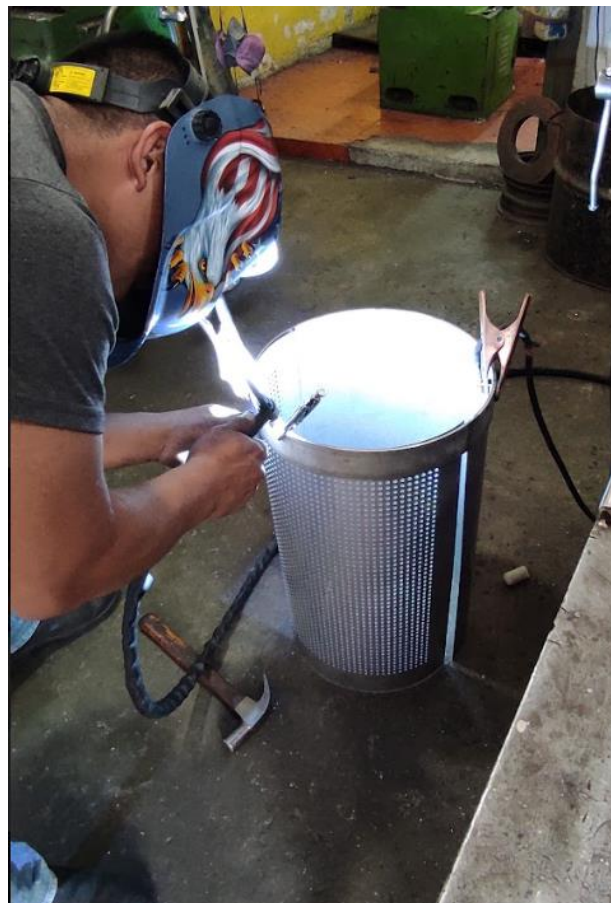
Figura 56. Suelda TIG para el tamiz. Fuente: Propia
