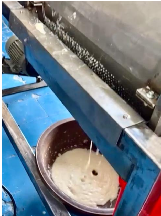
Figura 65. Proceso de despulpado, pulpa saliendo por la tolva y almacenándose en un recipiente. Fuente: Propia.
