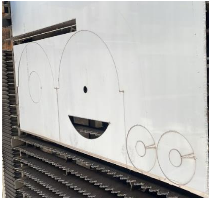
Figura 58. Corte laser de las paredes de la despulpadora y los helicoides para el transportador. Fuente: Propia.
