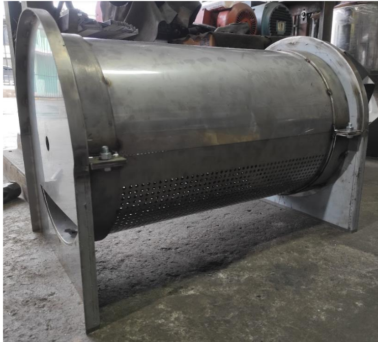
Figura 59. Ensamblaje de las paredes de despulpado y el tamiz.
