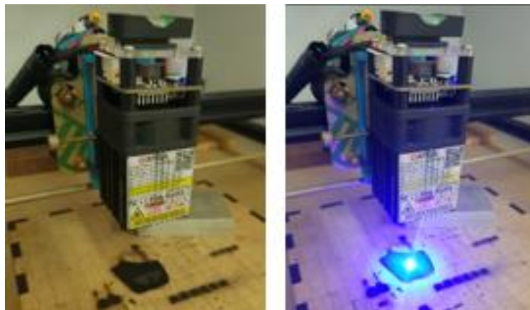
Figura 2.5. Proceso de grabado láser
