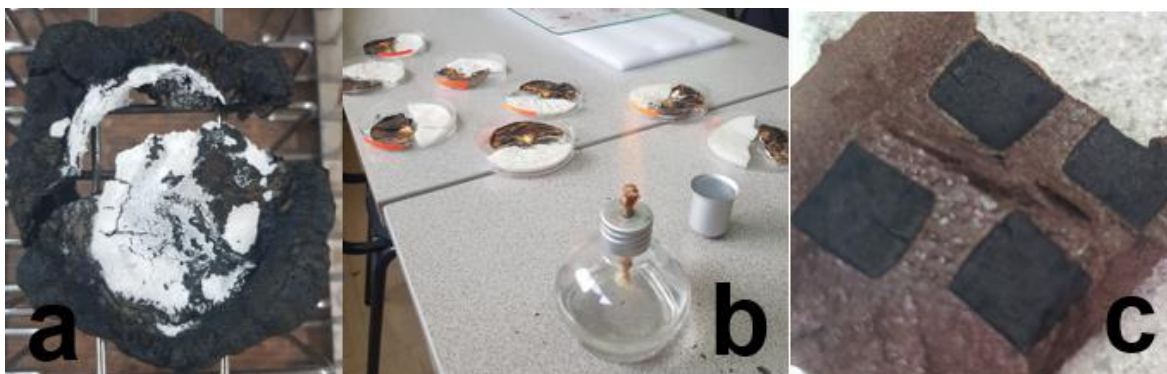
Figura 2.2. (a) Muestra calcinada en el horno a 230°C. (b) Muestras calcinadas con mechero. (c) Muestra #12 quemada con láser, la superficie negra fue un indicio de la obtención de grafeno
