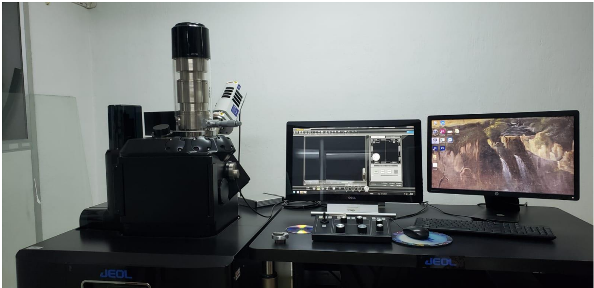
Figura 3.11. Microscopio electrónico de barrido (SEM) del Instituto Nacional de Patrimonio Cultural del Ecuador.
