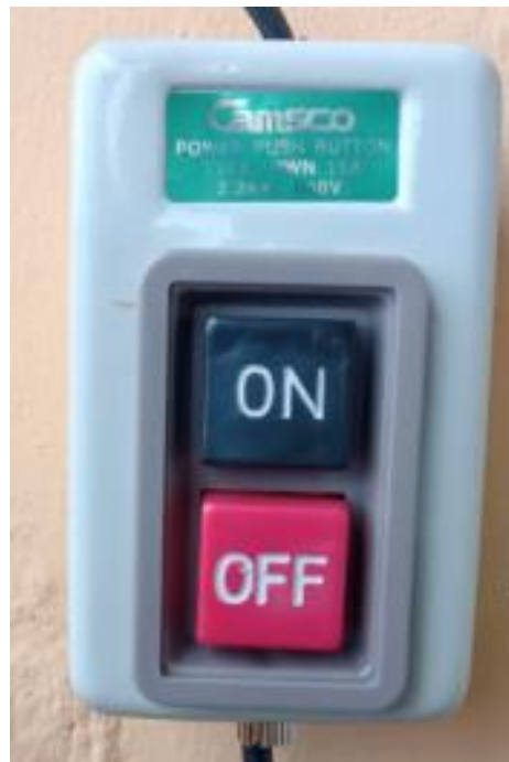
Figura 3.33. Botonera para la conexión de la armadura.
