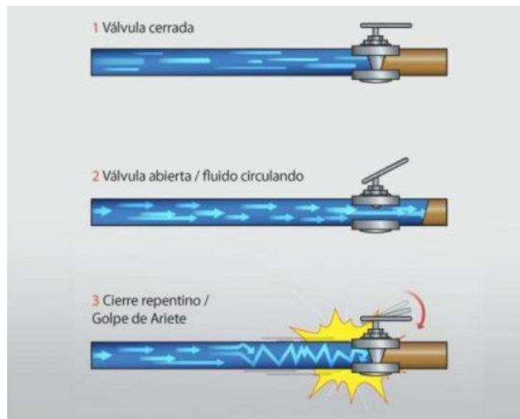
Figura 1.1. Representación gráfica del golpe de ariete en un sistema de distribución.
