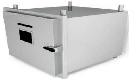
Fig. 4. Cámara de vacío en forma cúbica. [6]
