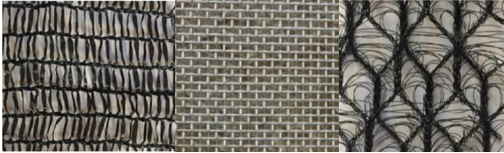
Figura 1.5: Tipos de malla usados en captadores de niebla [10]
