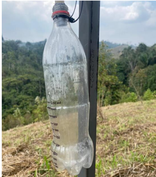
Figura 2.47: Sistema de almacenamiento de agua con escala
