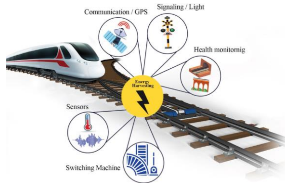
Figura 1.7. Aparatos que requieren de energía en los sistemas ferroviarios (Merino, 2021).
