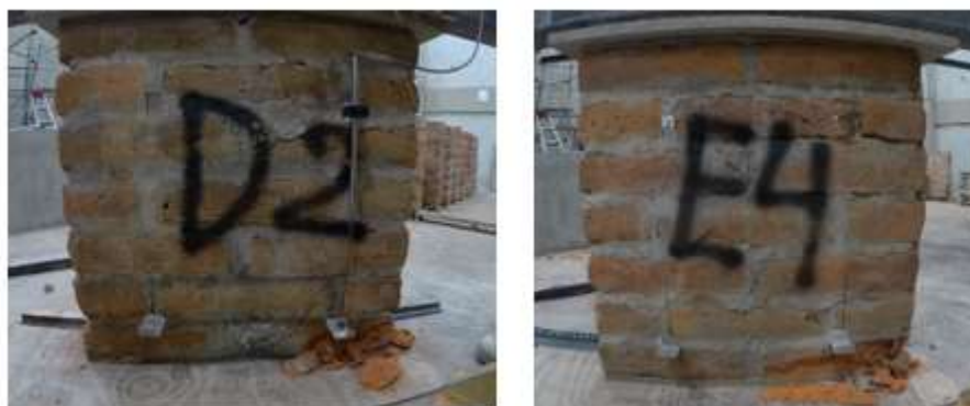
Figura 28. Muretes ensayados a compresión lotes D y E Fuente: elaboración propia
