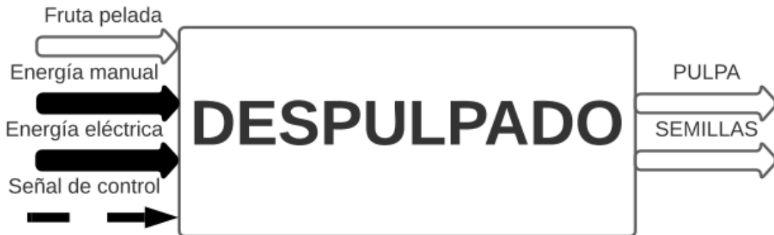
Figura 15: Diagrama funcional – nivel 0. Fuente: Autor
