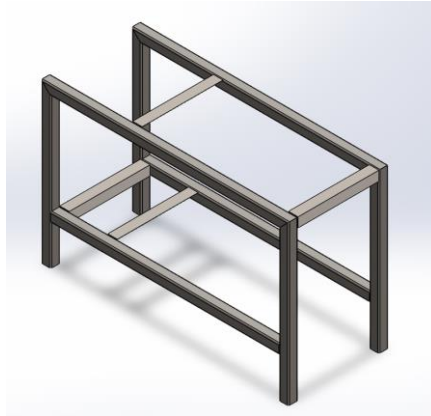
Figura 19: Estructura de perfil estructural cuadrado y ángulo. Fuente: Autor
