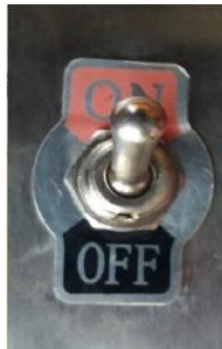
Figura 20. Switch del inversor de corriente (Escuela de operaciones SERTECPET, 2011).
