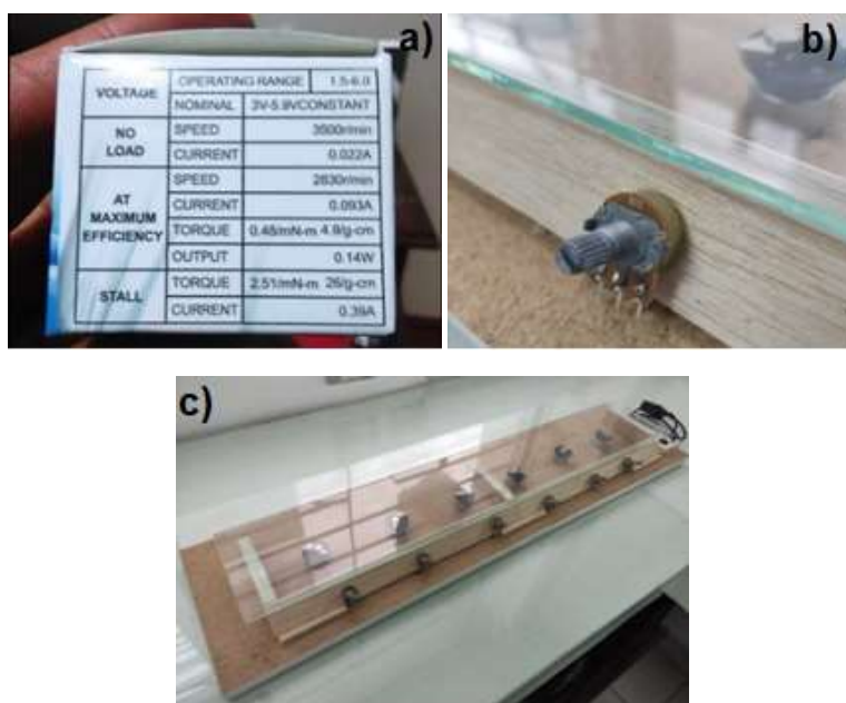
(a) Datos de placa de motor. (b) Potenciómetro de 1 K \Omega . (c) Plancha de agitadores magnéticos
