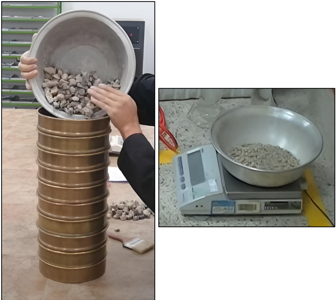
Figura A1. Procedimiento para realizar el análisis granulométrico por tamizado. (a) Introducción de la muestra en la columna de tamices. (b) Pesaje de la porción de muestra retenida en cada tamiz.
