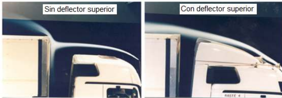
Figura 2. 2. Influencia del viento en la cabina de un camión (Fuente: [41]).
