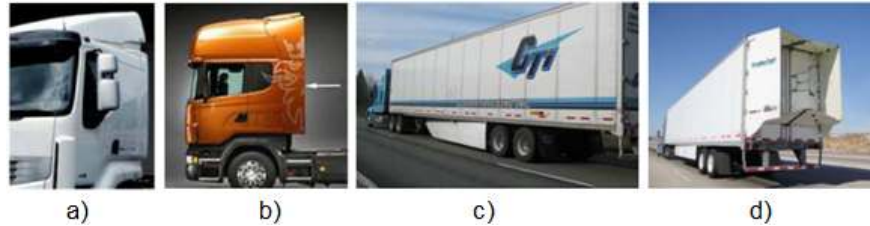
Figura 1.22. Dispositivos aerodinámicos. a) deflector superior b) reductor de espacios c) faldones laterales d) carenado posterior (Fuente: [37])
