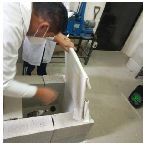
Aislamiento de la fuente y del ruido externo
