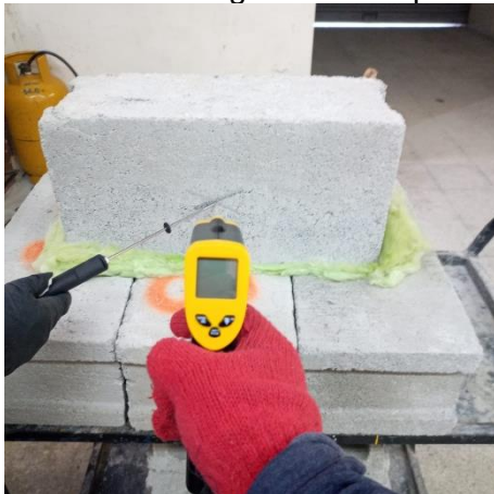
Registro de temperatura para conductividad térmica.
