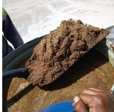
Eliminación del exceso de agua
