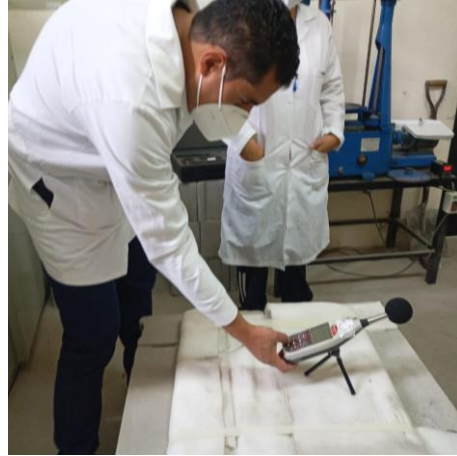
Medición de ruido sin aislamiento y ruido ambiental.
