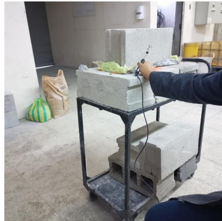
Registro de temperatura para conductividad térmica.
