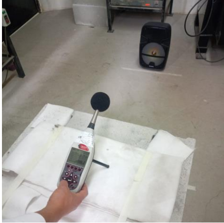
Medición de ruido sin aislamiento y ruido ambiental.
