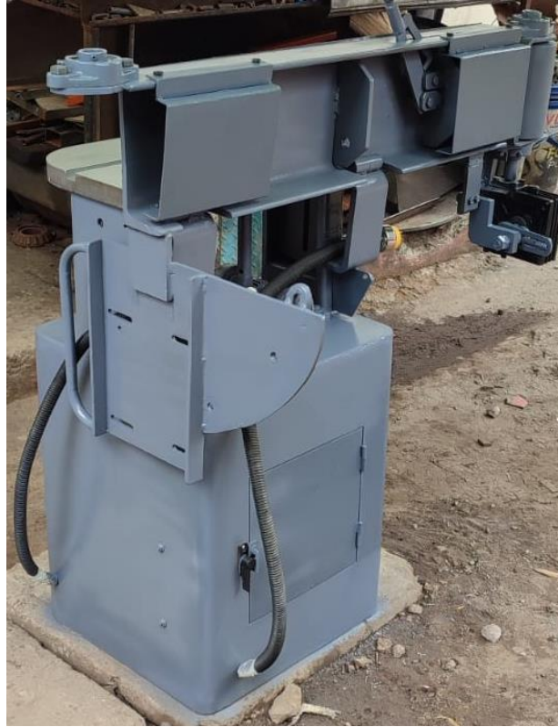
Figura 3.5 Vista posterior del mecanismo de movimiento horizontal y vertical del soporte de rodillo a 90°.
