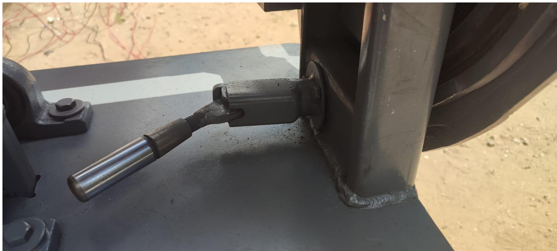
Figura 3.6 Vista frontal de la palanca de bloqueo de movimiento del soporte de rodillo.
