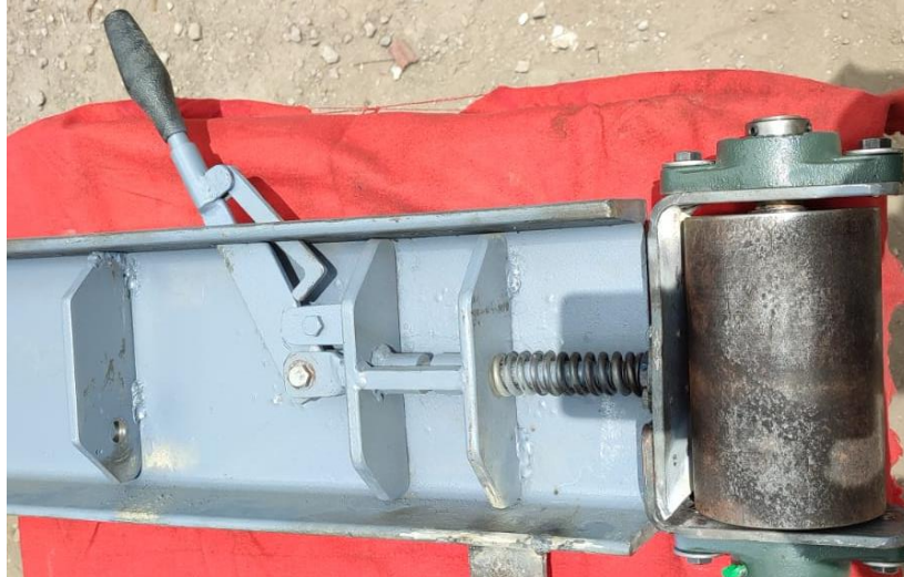
Figura 3.8 Mecanismo de ajuste y desajuste de banda de lija.
