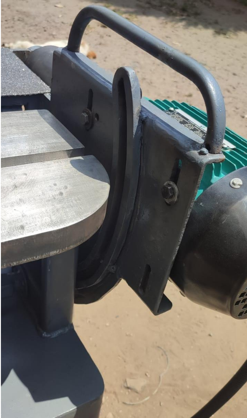
Figura 3.6 Vista frontal de la guía acoplada en la base del motor.
