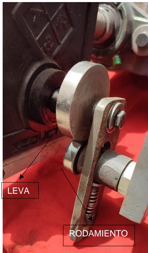
Figura 3.3 Mecanismo para el acople de la leva con el rodamiento.
