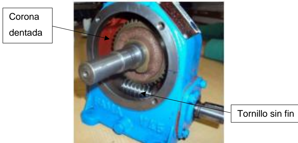
Figura 1.9 Partes de un reductor de velocidad, [15]
