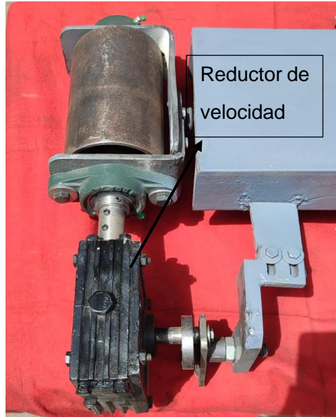
Figura 3.2 Vista frontal del sistema de oscilación de la lijadora de banda oscilante.
