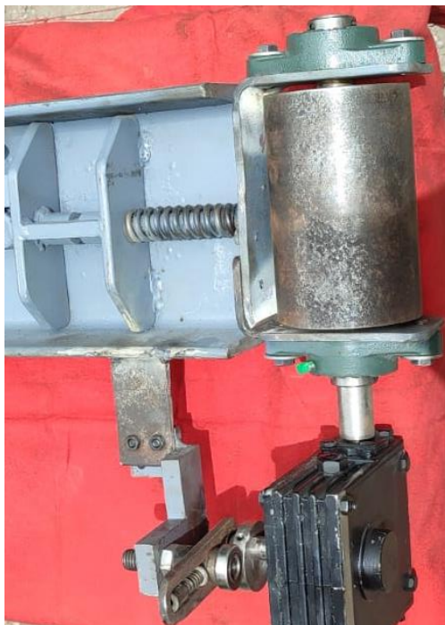
Figura 3.4 Vista posterior del sistema de oscilación de la lijadora de banda oscilante.
