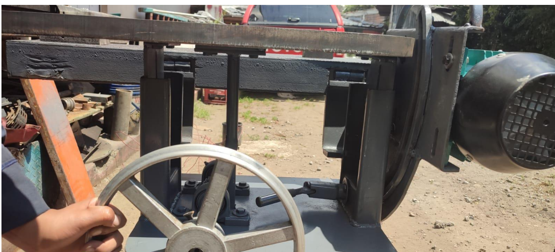
Figura 3.11 Vista frontal de la mesa de trabajo elevada, por medio del volante.
