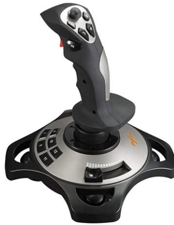
Figura 1.14 Joystick, controla hasta tres grados de libertad [4]
