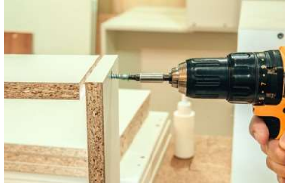
Figura X.IV. Proceso de atornillado de tablero MDF [57].
