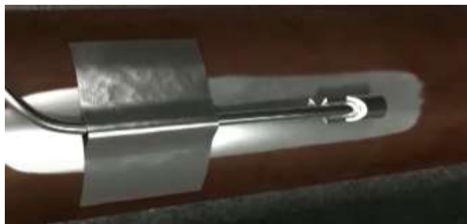
Figura X.XVII. Montaje RTD PT100 en la tubería de cobre [6].
