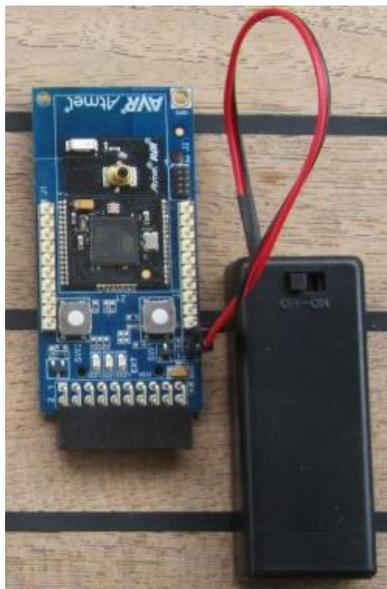
**Figura 1.25.** Conexión de la fuente de alimentación a la placa de desarrollo [32].
