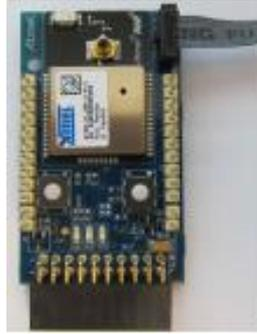
**Figura 1.24.** Conexión de la interfaz JTAG para programar la placa [32].
