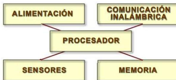
Figura 1.1. Arquitectura de un nodo sensor [4].
