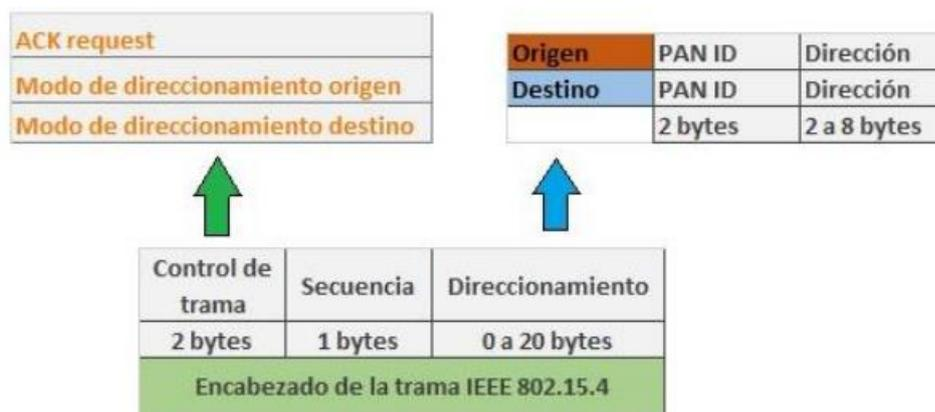
**Figura 1.19.** Información de direccionamiento dentro del encabezado de trama [15].
