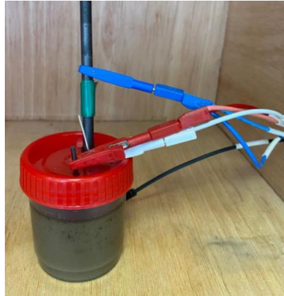
Figura 3.8 Celda voltamétrica acoplada con los electrodos
