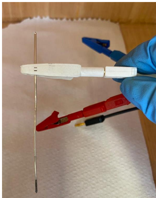
Figura 8.14 Contraelectrodo Barra de Grafito
