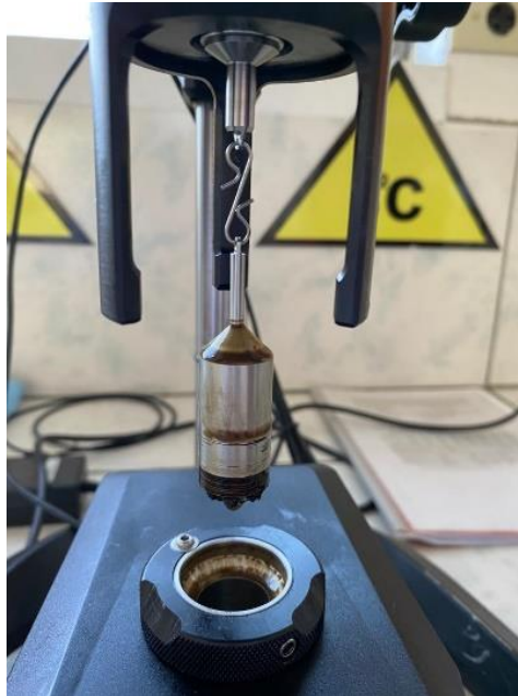
Figura 8.1 Husillo del Viscosímetro Elaborado por: (Quinaluiza, 2023)
