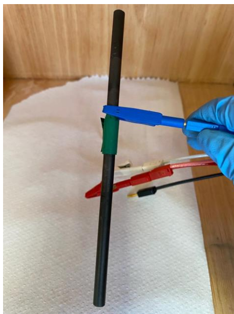
Figura 8.13 Contraelectrodo Barra de Grafito Elaborado por: (Quinaluiza, 2023)
