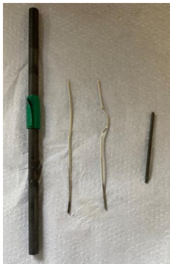
Figura 3.6 Electrodo de trabajo (grafito y plata)
