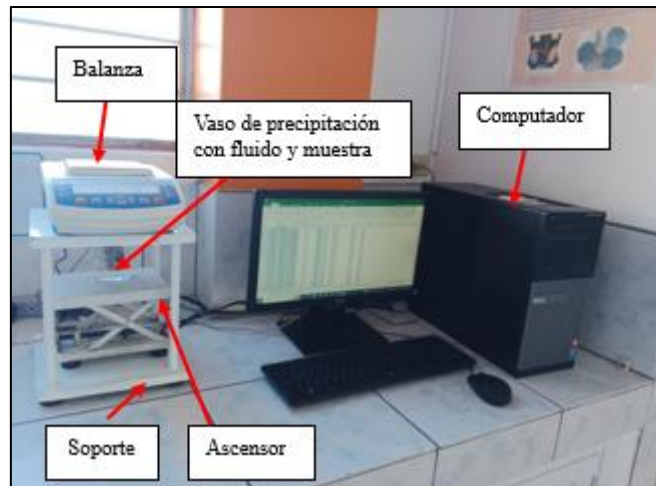
Figura 11. Esquema arreglo balanza-muestra-agua para prueba de imbibición espontánea.
