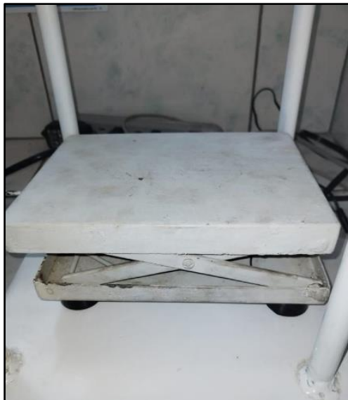
Figura 15. Dispositivo tipo ascensor
