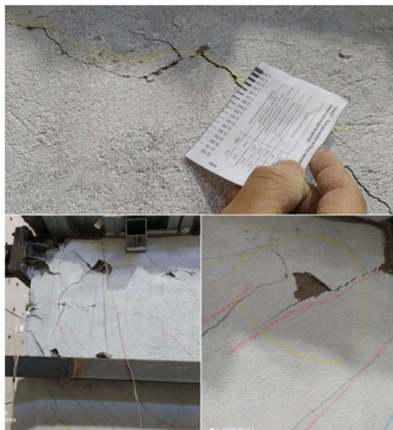
Figura 3.14. Prototipo II con daño previo, reforzado mediante enchape, ensayado a carga lateral en etapa “Daño moderado”. [21]
