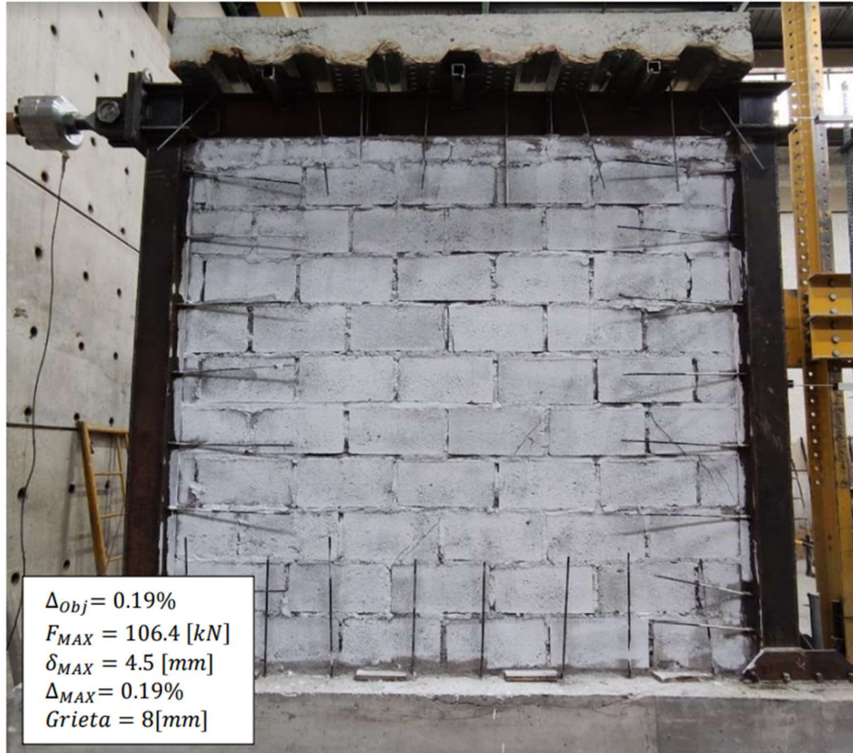
Figura 3.3. Prototipo I ensayado a carga lateral en etapa “Daño leve”. [22]
