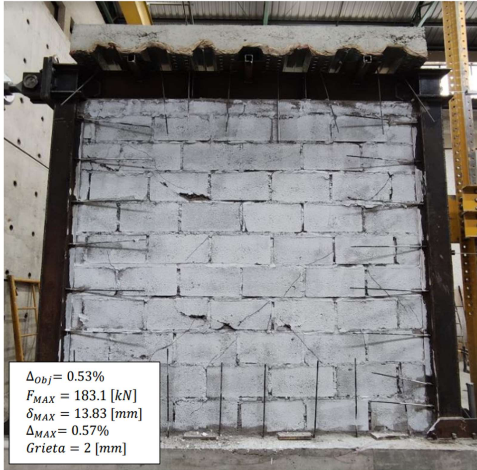
Figura 3.4. Prototipo I ensayado a carga lateral en etapa “Daño moderado”. [22]
