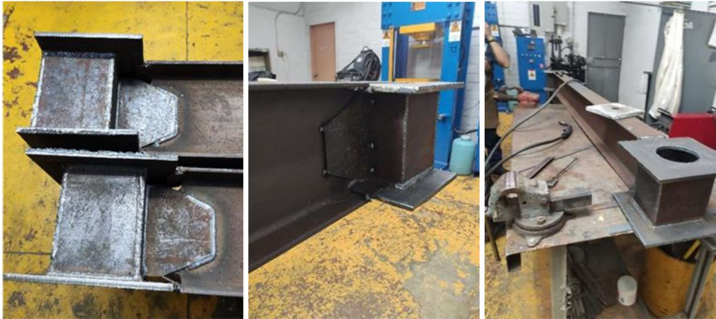
Figura 2.23. Armado de la unión viga-columna. [21]
