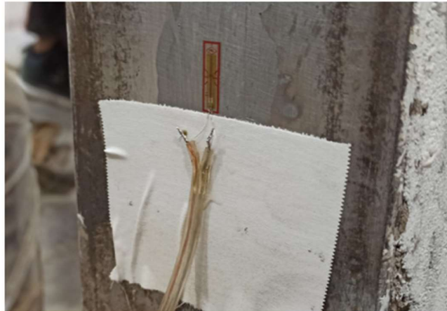
Figura 2.14. Strain gauge colocado en uno de los prototipos. Recuperado de [21].
