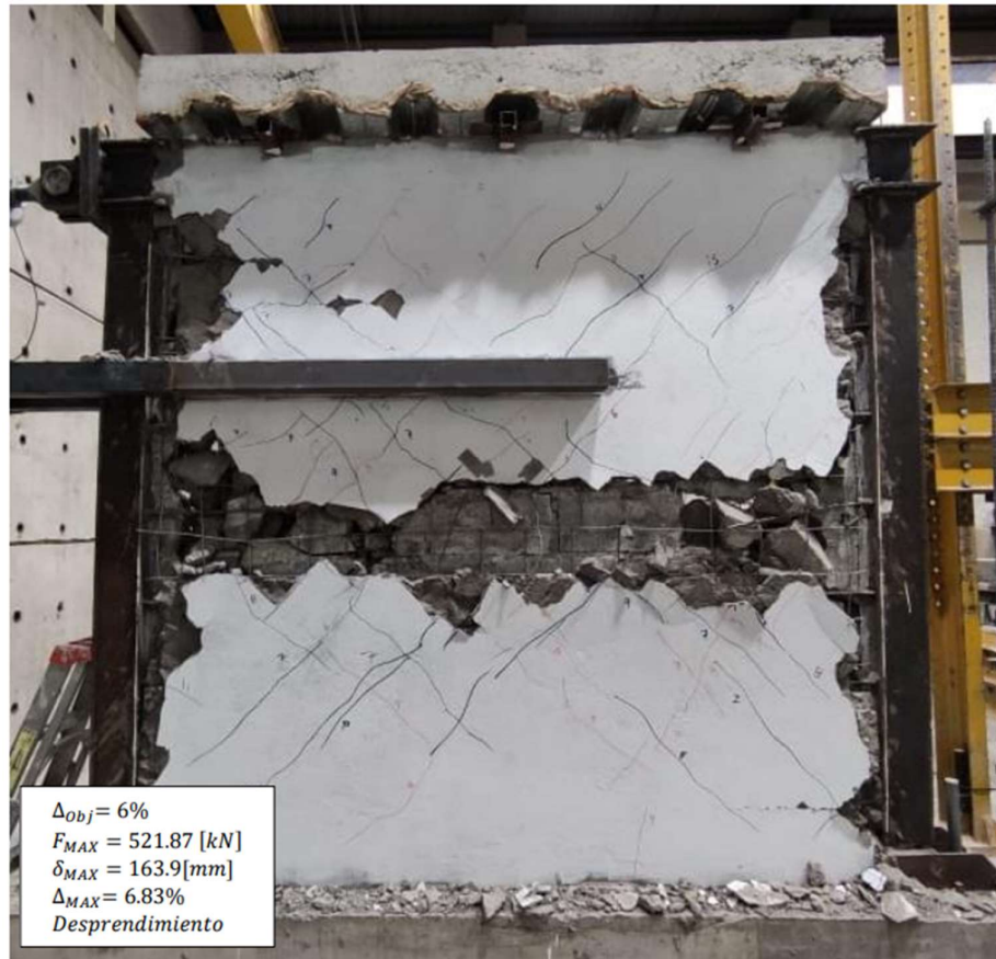
Figura 3.9. Prototipo I con daño previo, reforzado mediante enchape, ensayado a carga lateral en etapa “Daño completo”. [22]
