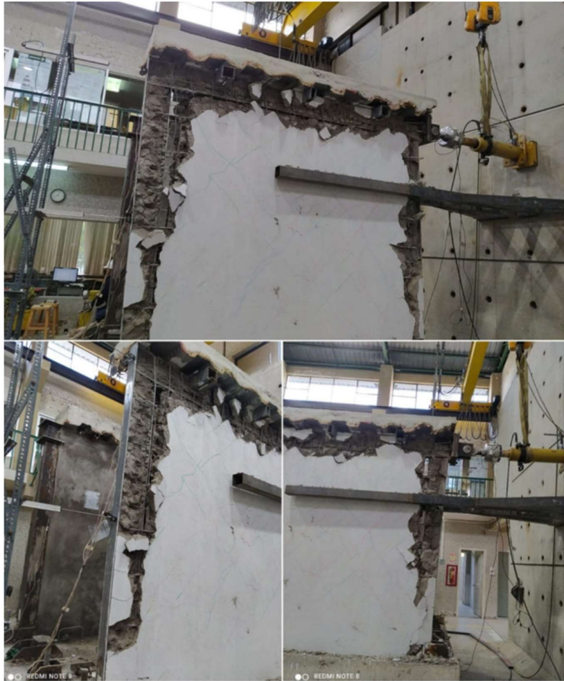
Figura 3.15. Prototipo II con daño previo, reforzado mediante enchape, ensayado a carga lateral en etapa “Daño extenso”. [21]
