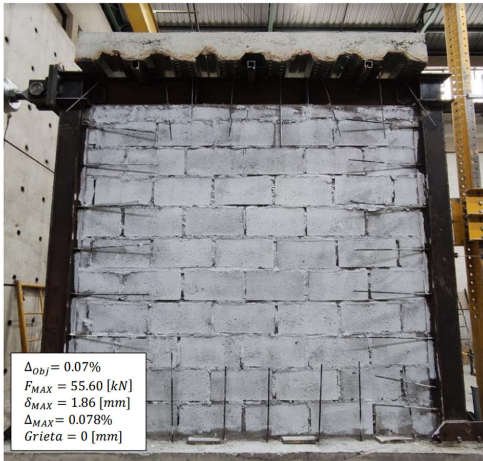
Figura 3.2. Prototipo I ensayado a carga lateral en etapa “Sin daño”. [22]
