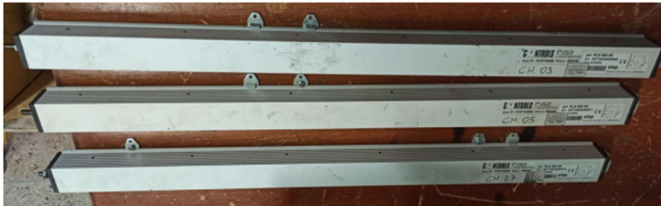
Figura 2.13. LVDT's utilizados para el registro de deformaciones. Recuperado de [21].
