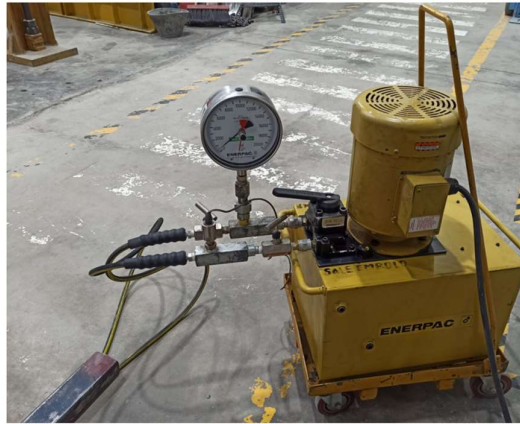
Figura 2.12. Bomba hidráulica y mangueras. Recuperado de [21].
