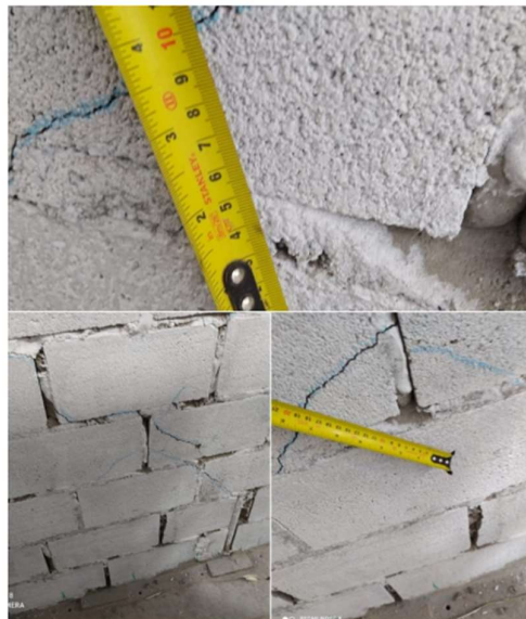
Figura 3.11. Prototipo II ensayado a carga lateral en etapa “Daño leve”. [21]
