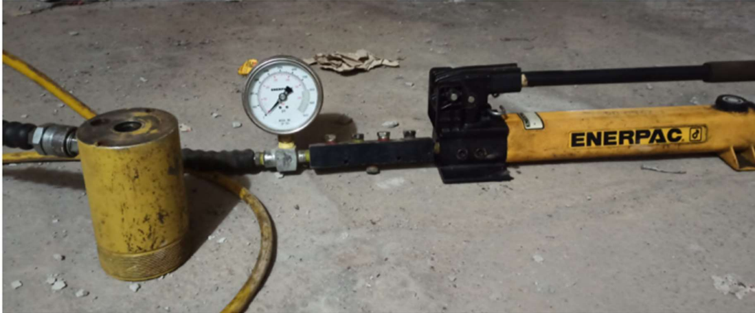
Figura 2.10. Cilindro manual de pretensión. Recuperado de [21].
