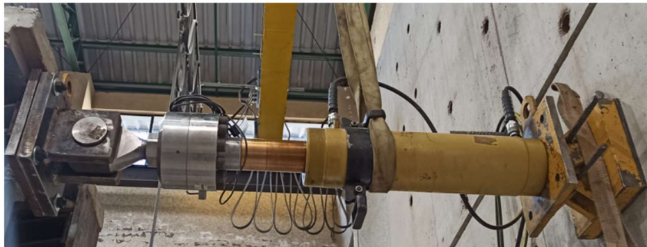
Figura 2.11. Gato hidráulico, placas de anclaje y celda de carga. Recuperado de [21].
