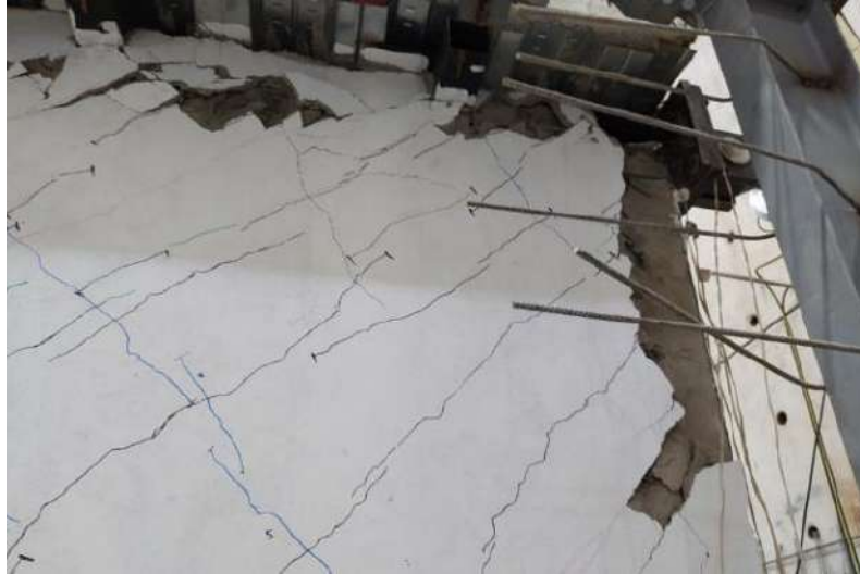
Figura 3.12. Daño Moderado de Pórtico Enchapado sin Daño en la Mampostería del Prototipo de Ensayo 2 [31].
