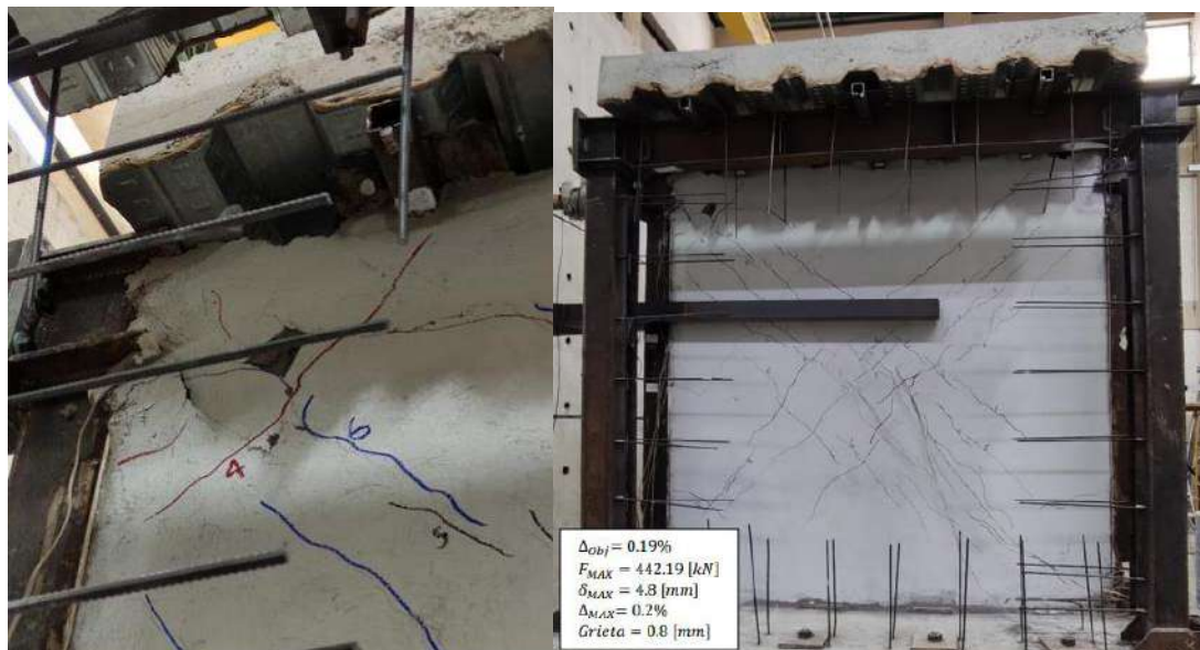
Figura 3.11. Daño Moderado de Pórtico Enchapado sin Daño en la Mampostería del Prototipo de Ensayo 1 [34].
