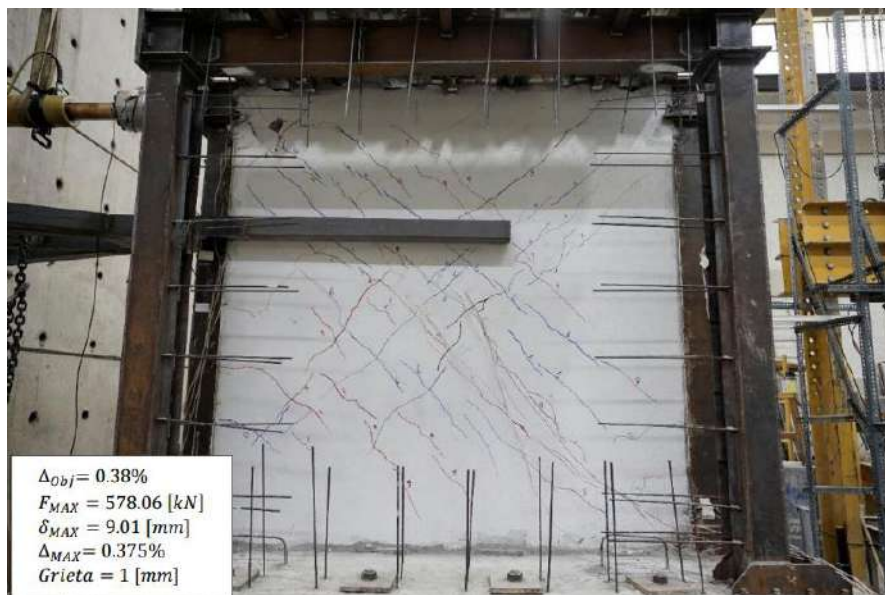
Figura 3.13. Daño Extenso de Pórtico Enchapado sin Daño en la Mampostería del Prototipo de Ensayo 1 [34].
