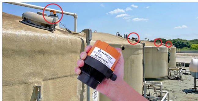
Figura 1.1. Sensor de Nivel en la Industria [2].
