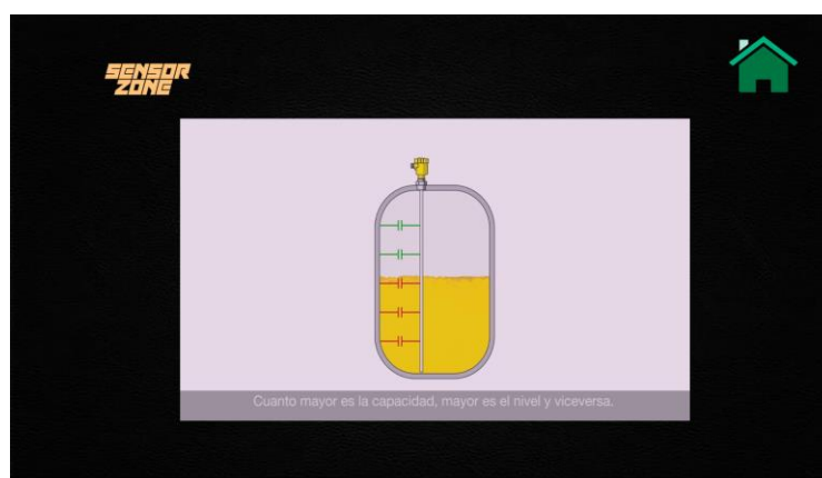
Figura 2.41. Escena del Funcionamiento del S.N. Capacitivo [12].
