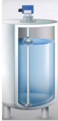
Figura 1.4. Principio de funcionamiento del S.N. Potenciométrico [5].
