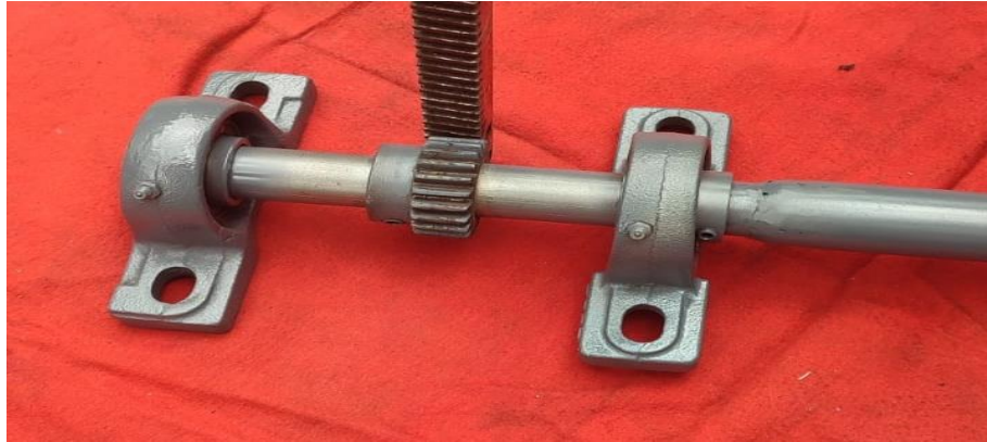
Figura 2.19 Implementación y fabricación del sistema de elevación de la mesa de trabajo
