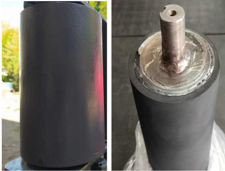
Figura 2.14 Resultado final de la fabricación de los rodillos
