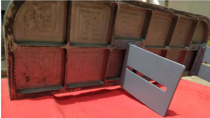
Figura 2.13 Fabricación de la mesa de trabajo por proceso de fresado en CNC
