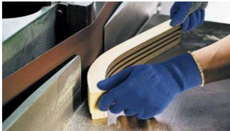
Figura 1.11 Proceso de lijado en la máquina de banda oscilante, [13]
