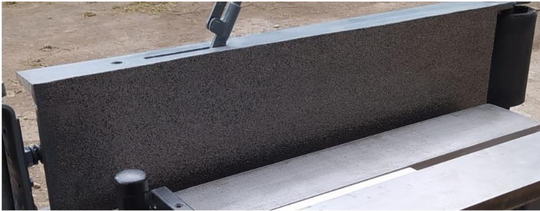
Figura 2.15 Fabricación de la mesa del soporte de la lija
