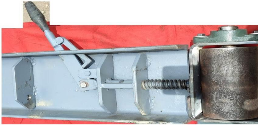
Figura 2.17 Fabricación del sistema de ajuste y desajuste de la banda de lija
