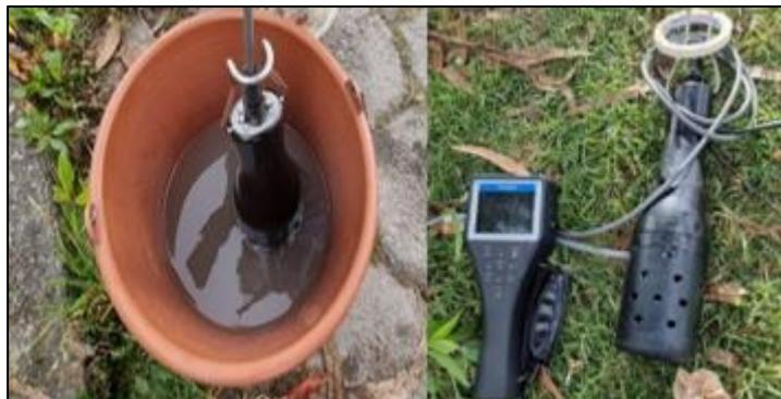
**Figura 14.** Medición in situ con multiparámetro.
