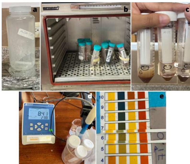
Figura 2.3: Fotografías de las sustancias y montaje experimental para la remoción del molde mesoporoso de sílice. a) Preparación de NaOH [2M]. b) Muestras con NaOH en el horno. c) Muestras después del proceso de centrifugación. d) Medida de pH del efluente de las muestras mediante un peachímetro. e) Medida de pH del efluente de las muestras mediante tiras de pH.
